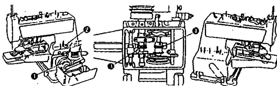
Чтобы обеспечить долгий срок службы машины и эксплуатировать её в состоянии ровного и плавного хода, машину нужно смазывать дважды в день перед пуском - утром и после обеда. Промасливайте все отверстия, указанные стрелками, белым шпиндельным маслом JIS social No. I
