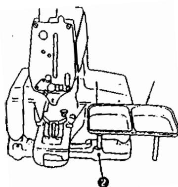
Обычно лоток для пуговиц устанавливается с правой стороны машины, но если, в зависимости от операции, эта позиция неудобна, открутите установочный винт ножки лотка для пуговиц и вставьте: отверстие с левой стороны передней части стола
