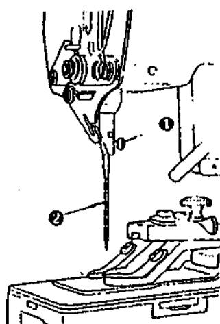
Чтобы вставить иглу, ослабьте зажимный винт иглы и вставьте иглу в игловодитель до упора длинной бороздкой, обращённой вперёд, затем надёжно закрутите винт.
