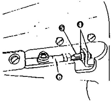
Стандартная величина регулировки - это зазор в 14,5 мм между передним передаточным рычагом механизма обрезки нити и поверхностью бороздки игольной пластины, как показано на рис
