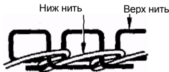
Ослабленные, плохие стежки получаются, когда верхняя нить не затянута
